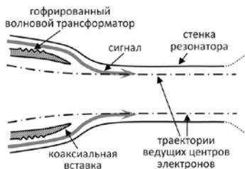
Схематическое изображение квазиоптической коаксиальной системы ввода излучения в модулирующий резонатор гироклистрона
